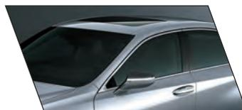
Teto solar elétrico com sistema antiesmagamento e acionamento por um toque
