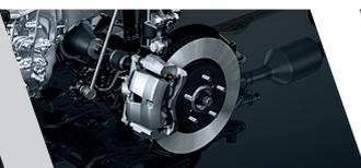
Sistema de freio a disco nas 4 rodas com ABS, EBD e BAS
